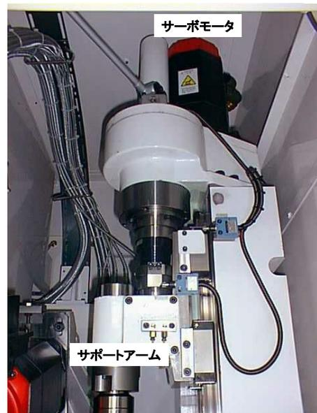
図8 サーボモータによるサポートアーム昇降
